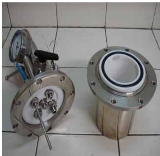
Figura 1. Reator de aço inox revestido com teflon utilizado na síntese da glicina
