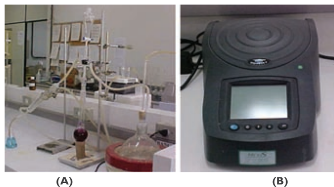
Figura 1. Sistema Kjeldahl tradicional para determinação de NKT (A) e o espectrofotômetro Hach (B) utilizado
