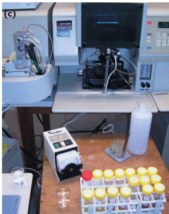
Figura 2. Sistemas de introdução de amostra utilizados para determinação de Cd nas amostras biológicas. (a) nebulização pneumática convencional, (b) microinjeção manual com funil e (c) microinjeção com sistema FIA.
