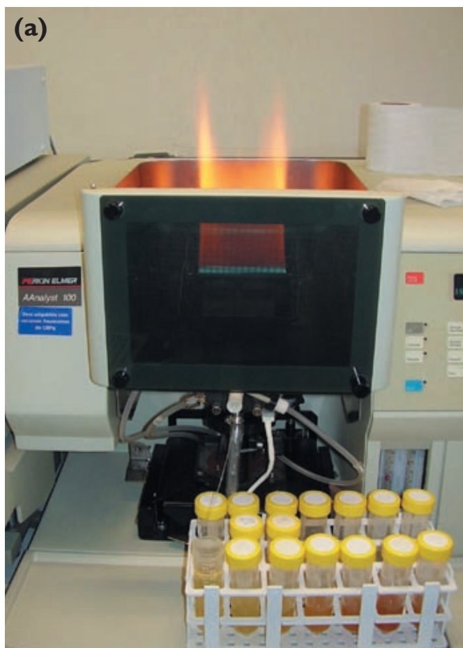
Figura 2. Sistemas de introdução de amostra utilizados para determinação de Cd nas amostras biológicas. (a) nebulização pneumática convencional, (b) microinjeção manual com funil e (c) microinjeção com sistema FIA.
