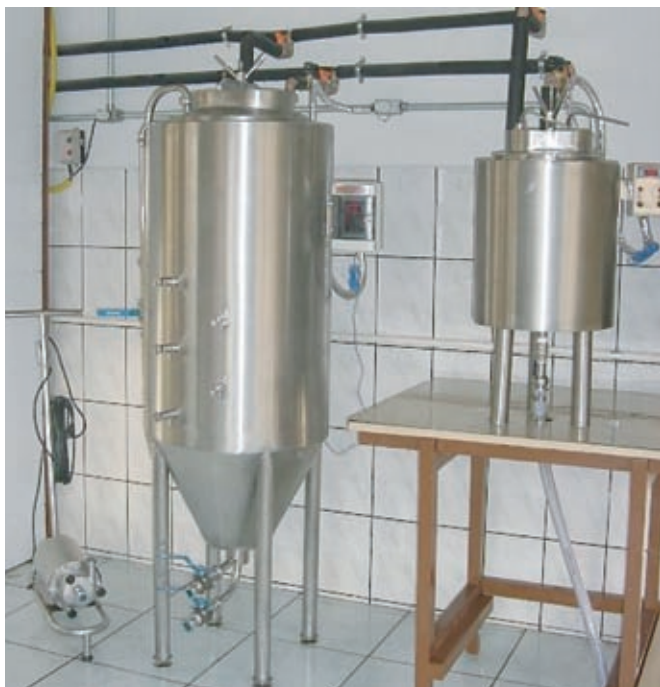
Figura 1. Fermentador / maturador da microcervejaria do Departamento de Biotecnologia da USP de Lorena (SP)
