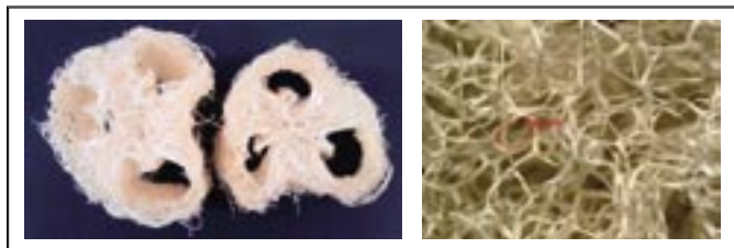
Figura 1. a) Corte transversal da esponja natural ( Luffa cylindrica ) e b) morfologia interna da esponja natural com 16 vezes de aumento.
